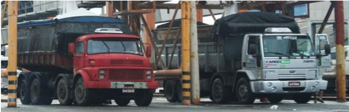
Figura 22 Veículo tipo 4C comum verificada na contagem volumétrica (FONTE: Autor).
